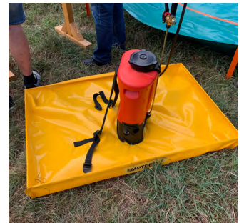
Mobile Blache mit angehobenem Rand für das Befüllen kleinerer Spritz- und Sprüheräte
