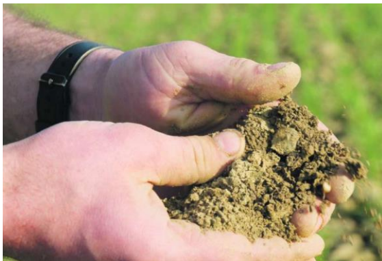
Immagine 3: Risultato della prova tattile => terreno argilloso
