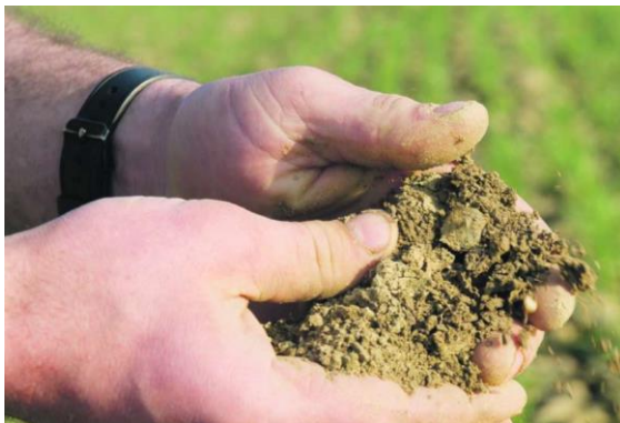
Abbildung 3: Resultat der Fingerprobe => lehmiger Ton
