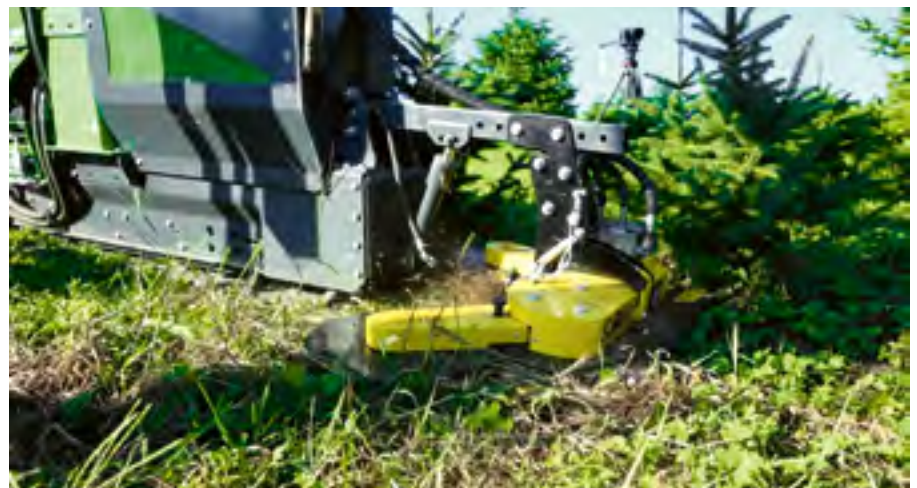
Am Geräteträger können beispielsweise bis zu drei Mulcher für Christbaumkulturen montiert werden.
