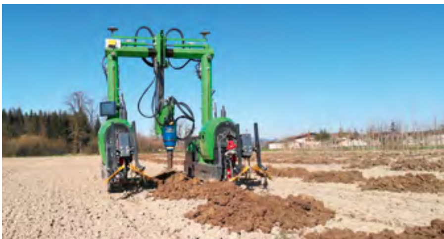
Mit dem Pflanzlochbohrer am Zentralhubwerk können Löcher von 50 bis 100 cm Durchmesser vollautomatisch gebohrt werden.
