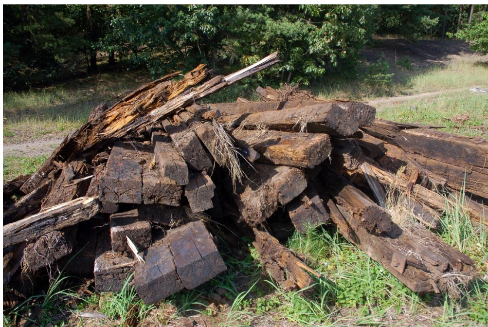
Traversine ferroviarie impregnate con olio di catrame
