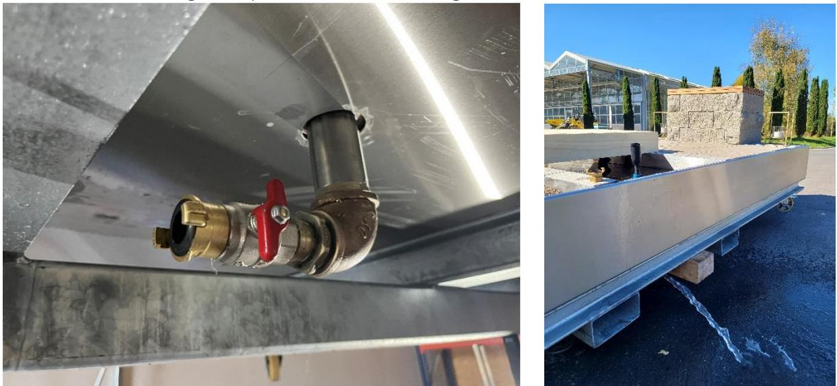
Pour cela, il faut un tuyau avec un raccord GEKA. Acheminer l'eau avec un tuyau vers un caniveau/regard.
