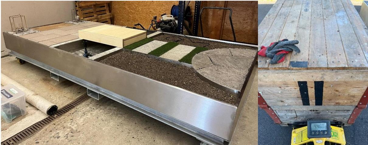
2. Démontez les éléments du jardin et les déposez sur le côté. Toutes les constructions sont numérotées et peuvent être montées ou démontées individuellement.
