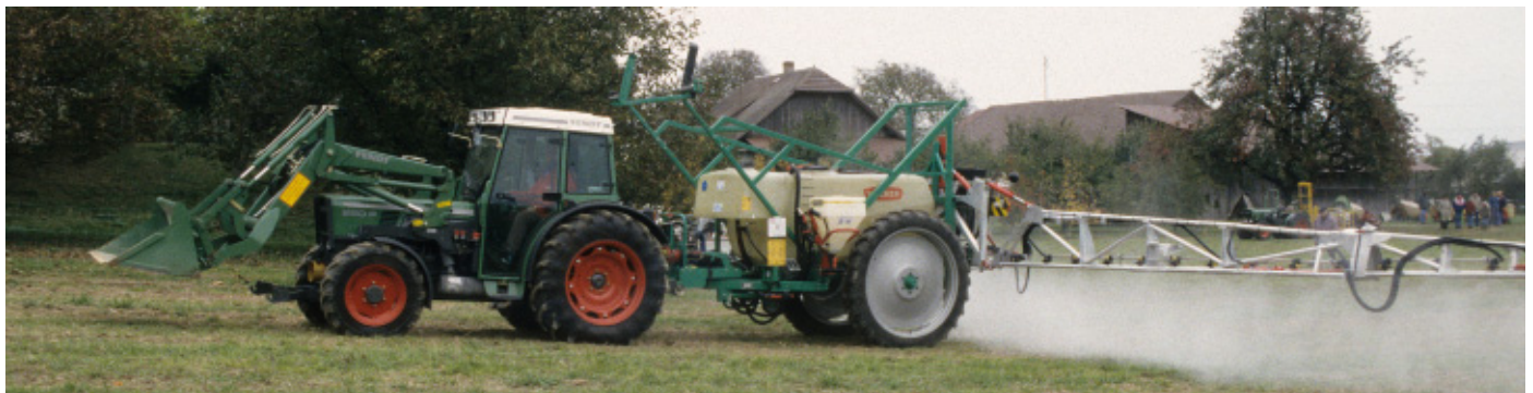
Beim Ausbringen von Pflanzenbehandlungsmitteln im Feldbau bietet eine geschlossene Traktorkabine ausreichenden Schutz. Kleine Reste der Spritzbrühe sind auf der gespritzten Kultur auszubringen.
