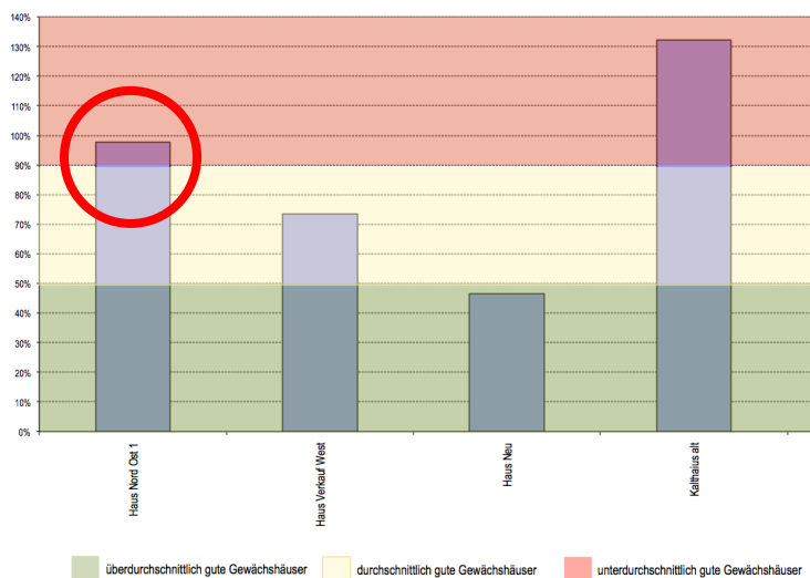
7. Energetische Qualität der Gewächshäuser
