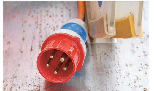
2 Drehstromstecker (CEE) sind rot, rund und 5-polig.
