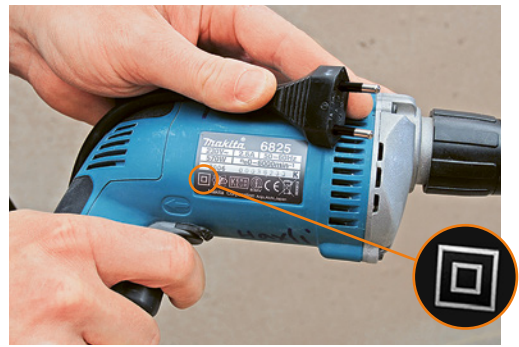
1 Bohrmaschine der Schutzklasse II mit entsprechender Kennzeichnung.
